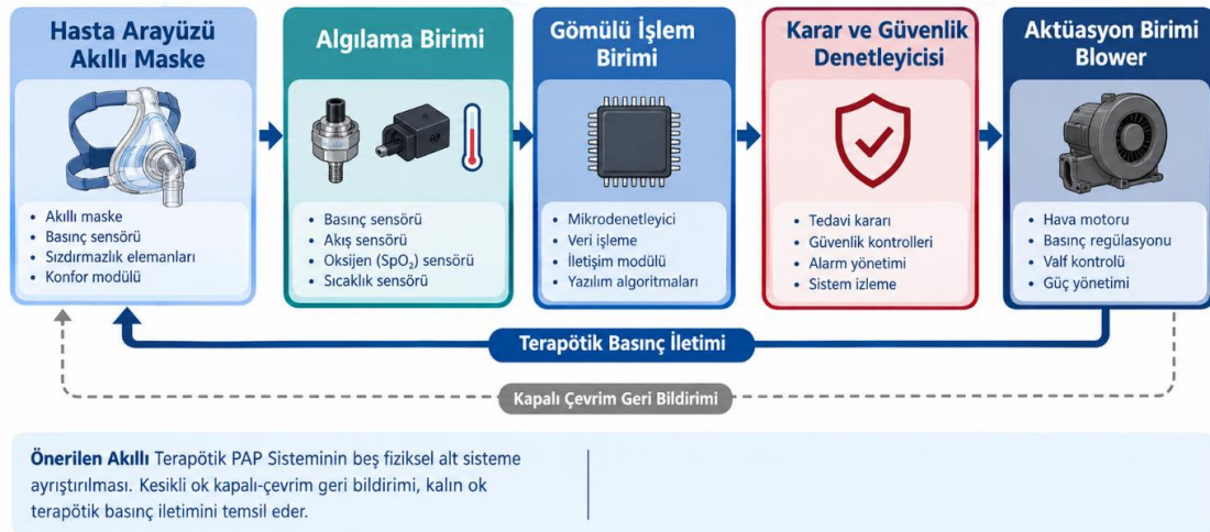
Şekil 2. Önerilen akıllı terapötik PAP sisteminin fiziksel alt sistem mimarisi ve kapalı çevrim kontrol yapısı.
